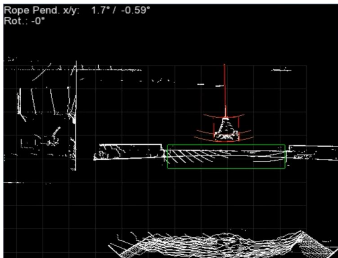
3D-Echtzeitverfolgung eines Greifers, Luken- und Ladungsscan
