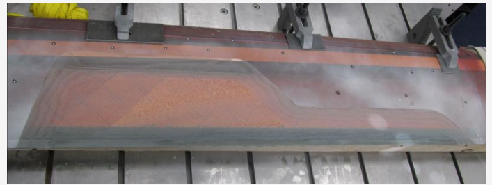
Abbildung 5: CFK-Bauteil (Rotorblatt) mit Schäftung
